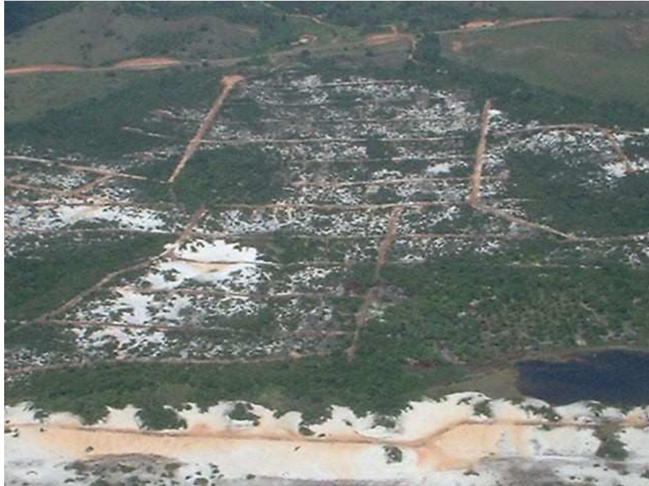
Figura 3.5.13 – Loteamento sobre áreas de formação eólica, onde são claros os riscos de contaminação do lençol freático por cargas poluentes domésticas (fossas, sumidouros etc.)
